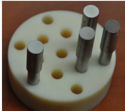
2. ábra. Próbatestek diffúziós hegesztésre előkészített felülettel
