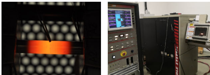
1. ábra. Diffúziós hegesztési kísérlet a Dunaújvárosi Egyetem Gleeble 3800-as termomechanikus szimulátorán
